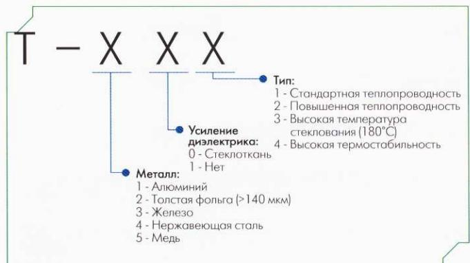
Рис.6 Маркировка материалов компании Totking
