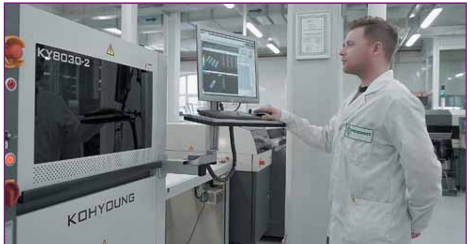
Рис. 16. 3D-контроль качества нанесения паяльной пасты на оборудовании KohYoung 8030-2
