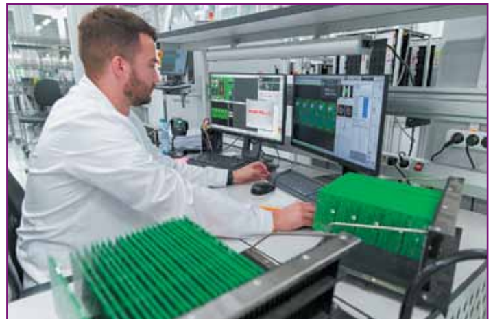
Рис. 18. Контроль на review station, пост-контроль АОИ
