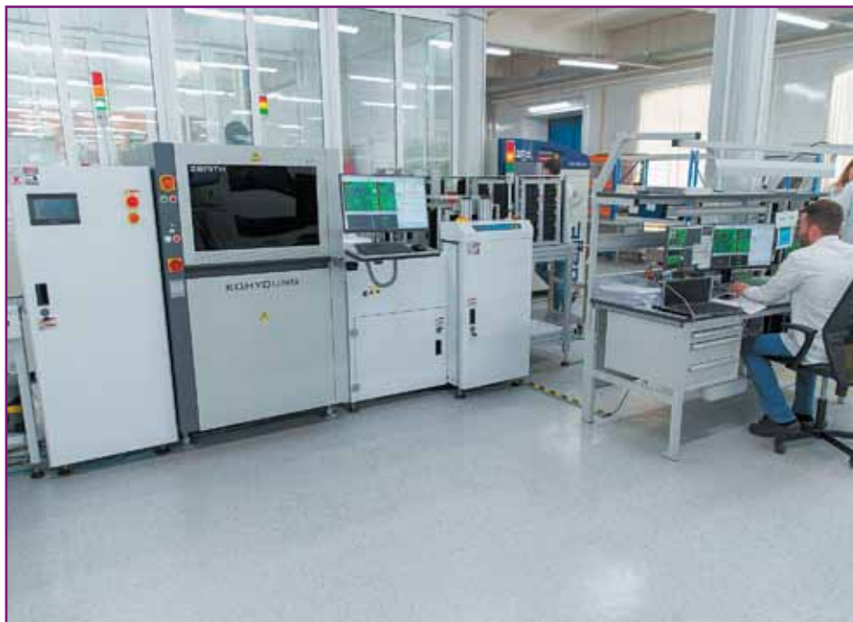
Рис. 19. Встроенная в линию система 3D-инспекции Zenith
