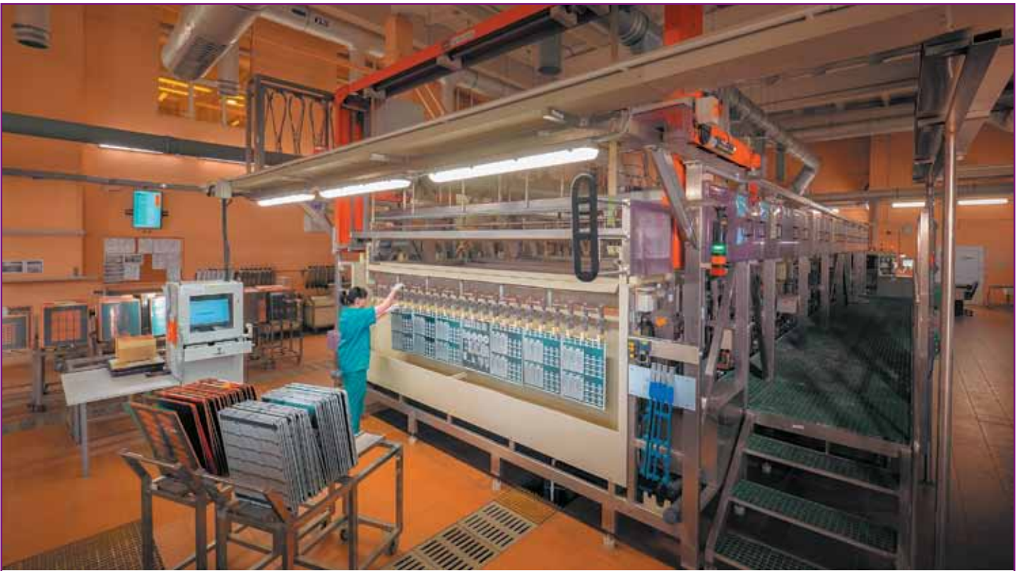
Рис. 14. Автоматическая гальваническая линия на производстве печатных плат в технопарке Зубово
