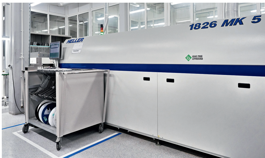
Печь конвекционного оплавления Heller 1826 MK5
