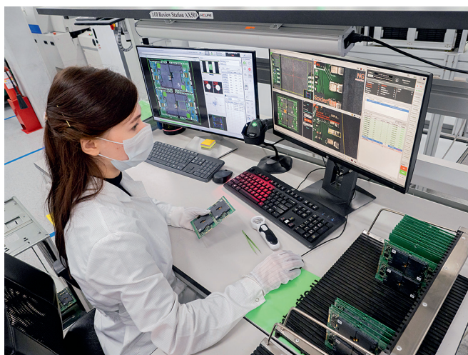
Станция проверки несоответствий, выявленных системой АОИ
