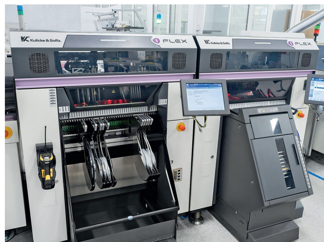
Автоматы установки компонентов серии iFlex
