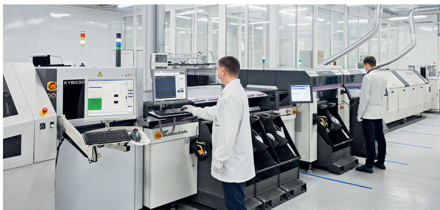
Гибкая линия с чип-шутером iX 302 и двумя установщиками iFlex от Kulicke & Soffa
